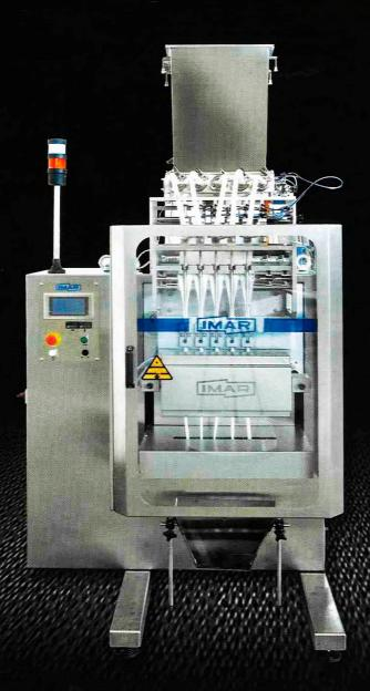
Machine ensacheuse automatique pour PRODUITS VISQUEUX ET LIQUIDES en sticks thermosoudés sur 3 côtés type «Êstick packÊ» qui se forment, se remplissent et se ferment en un seul cycle, en partant d'une bobine de matériel thermo soudable avec le centrage d'impression.
